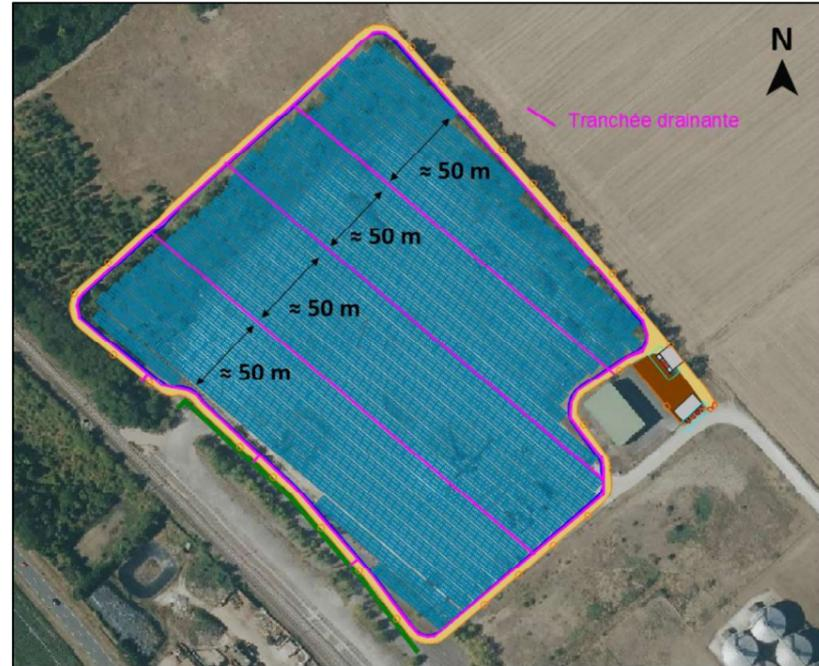
Figure 33 : Vue en plan de l'implantation des tranchées drainantes proposées
