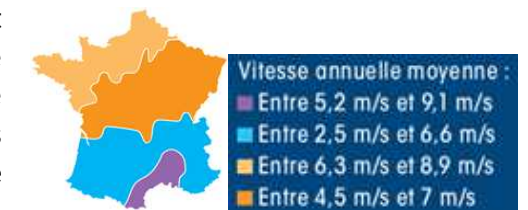
Figure 1 : l'aléa éolien en France avec ses quatre zones de vent homogènes
