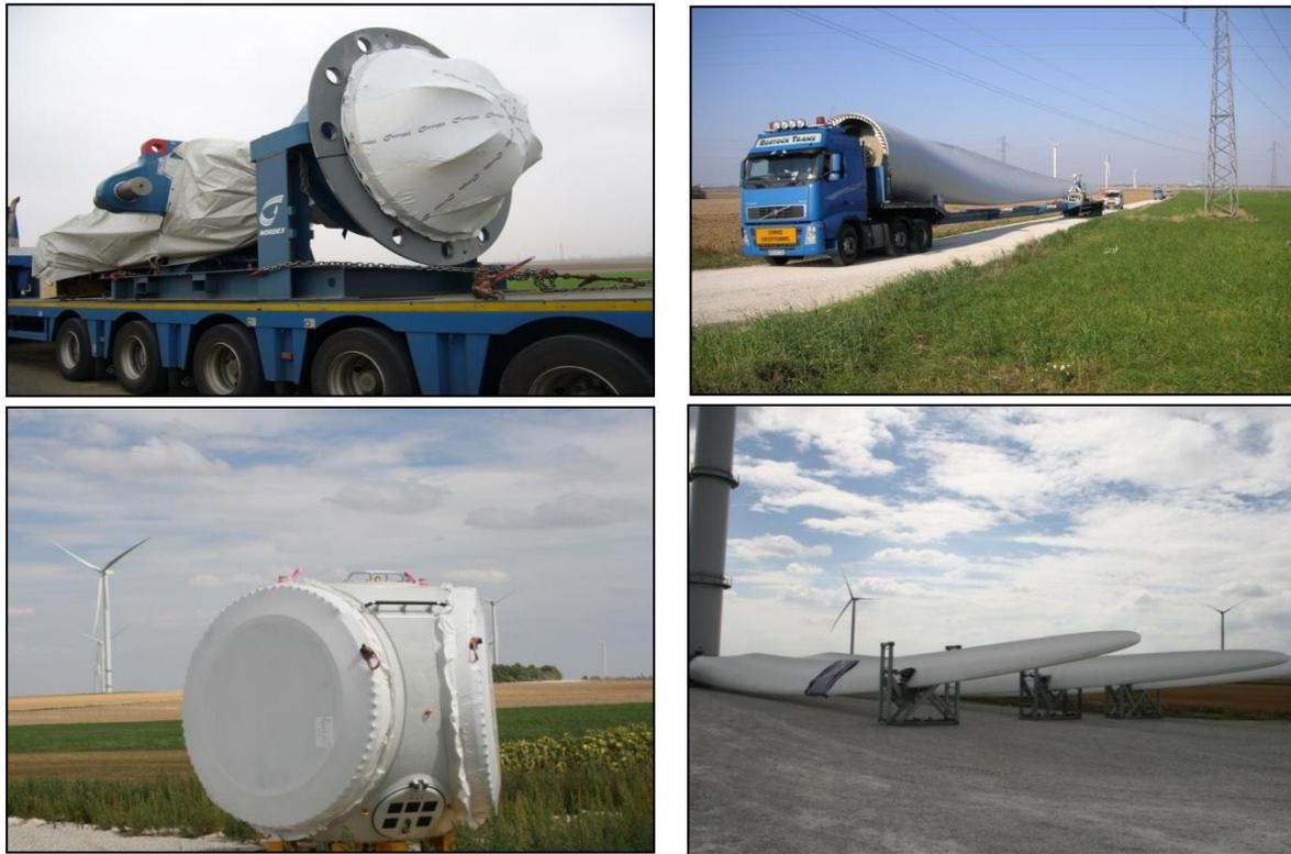
Figure 14 : Photos illustrant l'acheminement et le stockage des éléments des éoliennes – Source : NORDEX
